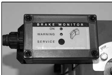
Пример индикатора износа (ABV)
